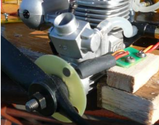
Příklad uchycení držáku magnetů a Hallový sondy
